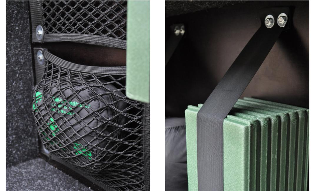
ABB. 16-18: NETZTASCHEN, GUMMIBÄNDER, BUTTERFLY VERSCHLUSS, DETAILANSICHT PROTOTYP
