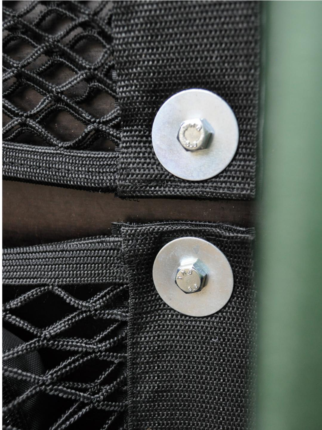
ABB. 15: SCHRAUBVERBINDUNG, DETAILANSICHT PROTOTYP
